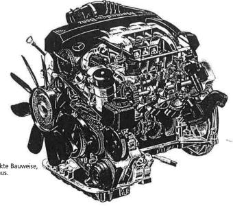
Der V6-Motor von Mercedes-Benz. Leichtbau (Motorgewicht 149; bisher 199 kg), kompakte Bauweise, geringer Verbrauch und drastisch gesenkte Abgaswerte zeichnen das neue Triebwerk aus.
